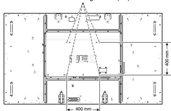
Les accessoires de montage peuvent être fixés au moniteur quand l'écran se trouve face vers le bas. Pour éviter d'endommager la surface de l'écran, placez la feuille de protection sur la table en dessous de l'écran LCD. La feuille de protection entourait l'écran dans l'emballage d'origine. Assurez-vous que rien sur la table ne peut endommager le moniteur.
