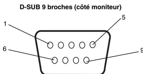
Ce moniteur LCD utilise des lignes RXD, TXD et GND pour le contrôle du RS-232C.
