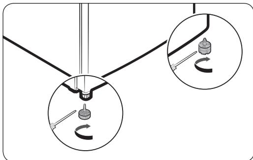
Mettez le réfrigérateur à niveau en réglant ses pieds manuellement. Tournez les pieds de mise à niveau dans le sens horaire pour les abaisser ou dans le sens antihoraire pour les lever. Pour des raisons de sécurité, le côté avant doit être légèrement plus élevé que le côté arrière.
