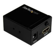
Este amplificador de señal HDMI le permite aumentar la potencia de la señal de su fuente de vídeo HDMI, a fin de poder conectar una pantalla HDMI situada a hasta 35m de distancia, mediante el uso de cables HDMI convencionales. Puede colocar el amplificador alineado entre dos cables HDMI, a una distancia de hasta 25m de la entrada de vídeo, y hasta 10m de la salida de vídeo.
