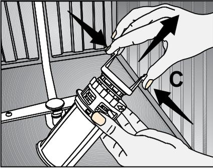
4. Reinigen Sie alle drei Filter mit einer Bürste unter fließendem Wasser.
