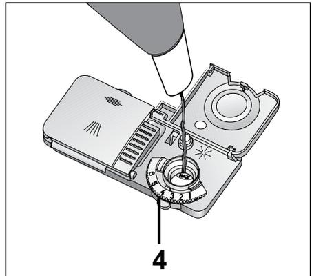
4. Stellen Sie die Klarspülerdosierung manuell auf eine Position zwischen 1 und 6 ein (4). Falls nach dem Spülen Flecken am Geschirr verbleiben, stellen Sie eine höhere Stufe ein. Sollte eine bläuliche Färbung nach dem Abwischen des Geschirrs von Hand zurückbleiben, wählen Sie eine niedrigere Stufe. Ihr Gerät ist ab Werk auf Position 4 voreingestellt.
