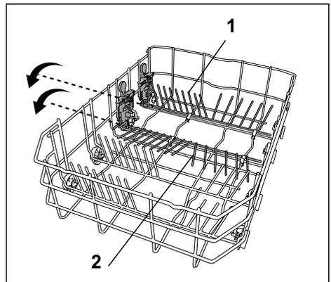
Sie können mehr Platz schaffen, indem Sie die Halterungen einzeln oder alle auf einmal umklappen. Zum Einklappen drücken Sie den Hebel (A).
