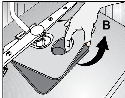
3. Drücken Sie die beiden Sperren am Grobfilter nach innen, lösen Sie den Grobfilter von der Baugruppe (C).
