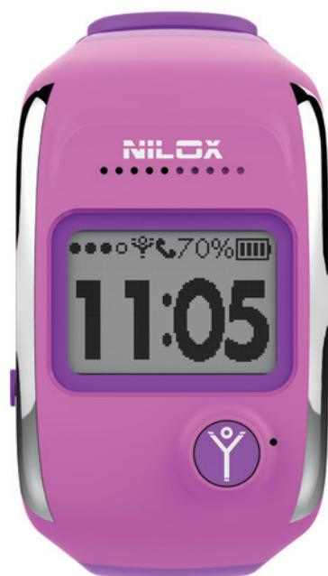
**bodyguard®** supporta esclusivamente schede microSIM. Inserisci, a **bodyguard®** spento, la scheda microSIM con i contatti dorati rivolti verso il display, nello slot laterale ⑦. **bodyguard®** si accenderà automaticamente all'inserimento della microSIM.
